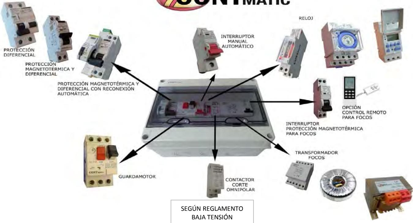
El cuadro de piscina de la fotografía superior corresponde a un cuadro que protege la bomba contra sobre intensidades, a través de un reloj horario podemos prefijar el tiempo de funcionamiento de la depuradora. Dispone de un interruptor para activar la depuradora de forma manual ó automática.
